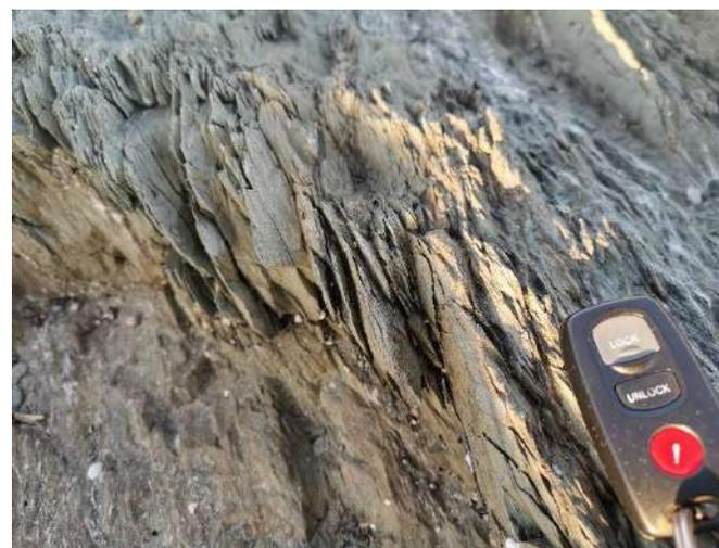
Photo 12. Photo micro du shale supposé. Friabilité élevée. Structure schisteuse évidente. (MERN)
