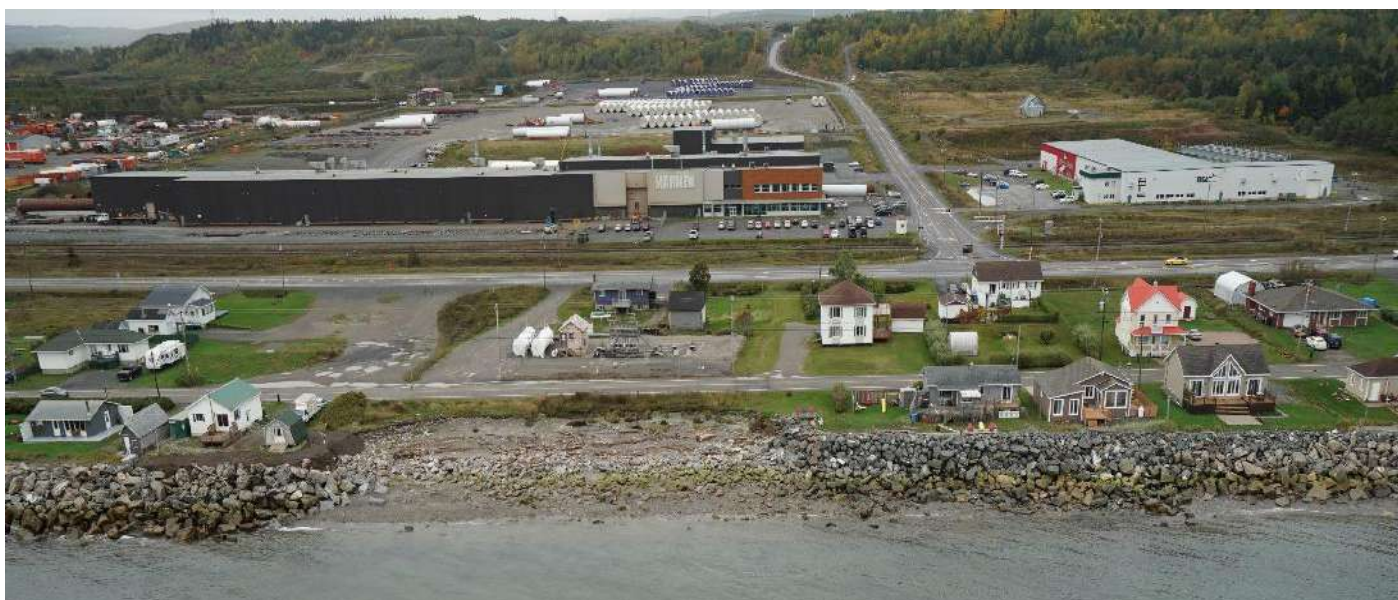
Image 12 : Section de petit Matane sans habitation et non enrochée exposant ainsi la route à l'érosion et à la submersion (issu de Pelletier-Boily, 2021, photo de 2017)
