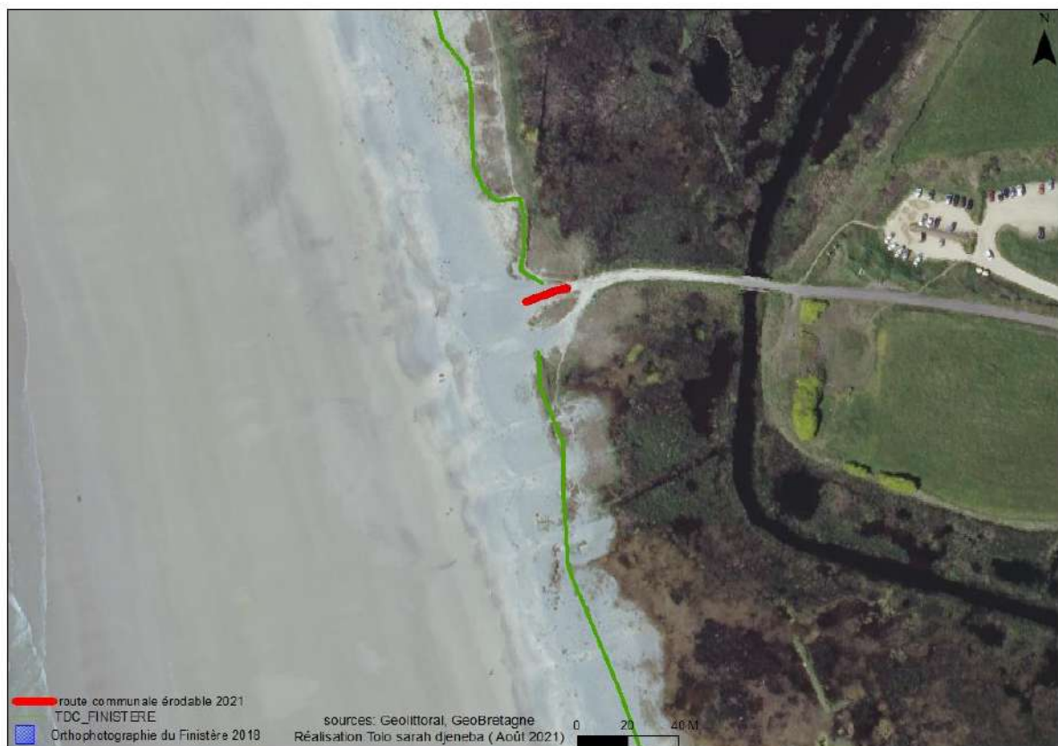
Figure 8 : Portion de route potentiellement érodable.
